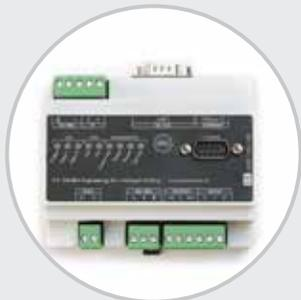
OmniLMG: Gateway-LON / LAN mit Verwaltung von bis zu 1200 Punkten mit interner Zwischenspeicherung der Befehle und Rückmeldungen.
